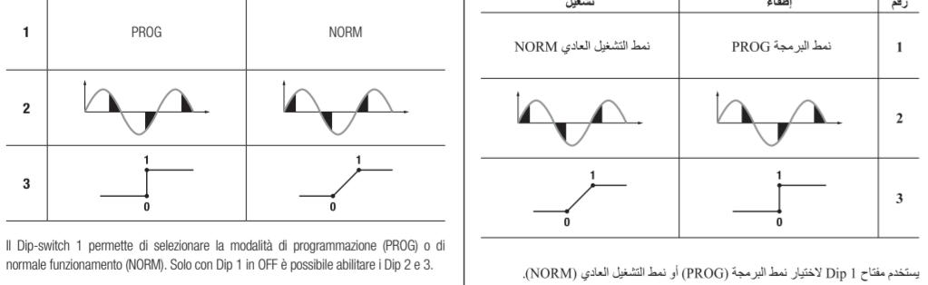
Il Dip-switch 1 permette di selezionare la modalità di programmazione (PROG) o di normale funzionamento (NORM). Solo con Dip 1 in OFF è possibile abilitare il Dip 2 e 3.
