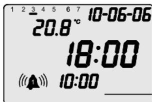
Con la tecla ▲ se procede cíclicamente a la activación/desactivación del despertador 1.
